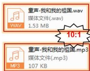
图 2 示例音频的数据量对比
